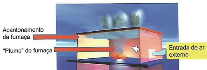
Sistema de controle de fumaça funcionando adequadamente com entrada de ar, acantonamento da fumaça e retirada da fumaça na cobertura.
